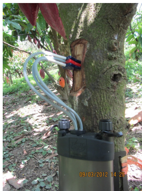
FIGURA 3. Sistema de pulso de calor con sensores y calentador insertados en el tallo de una planta de cacao.
