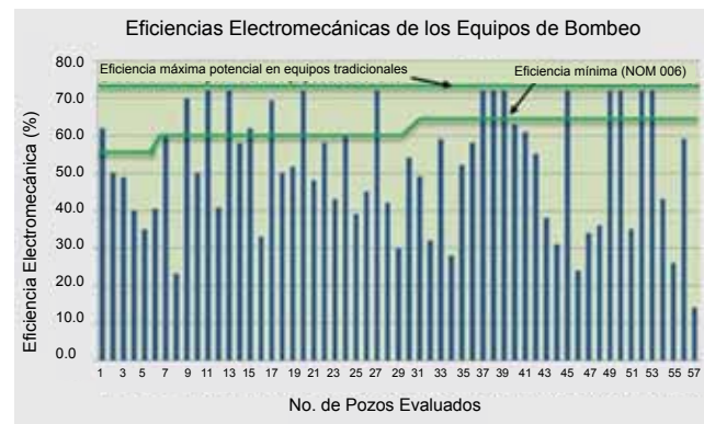
FIGURA 1. Resultados de 58 equipos de bombeo de pozo profundo evaluados con respecto a la eficiencia electromecánica.
