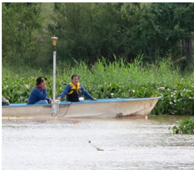
Figure 4. RTK equipment used for backup information. Figura 4. Equipo RTK usado como respaldo de la información.
