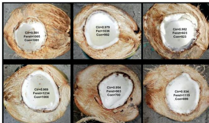
FIGURA 3. Parámetros de Feret, circularidad (cir) y tamaño h tal de la concha (con) en cocos cortados horizontalmente.
