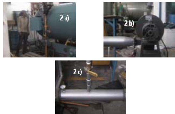
Figura 2. Sistema de aplicación de calor: a) caldera, b) ventilador, c) válvula esfera.
