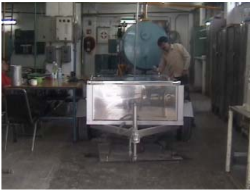
Figura 4. Equipo tipo remolque para desinfección en estático con vapor de agua-aireado.
