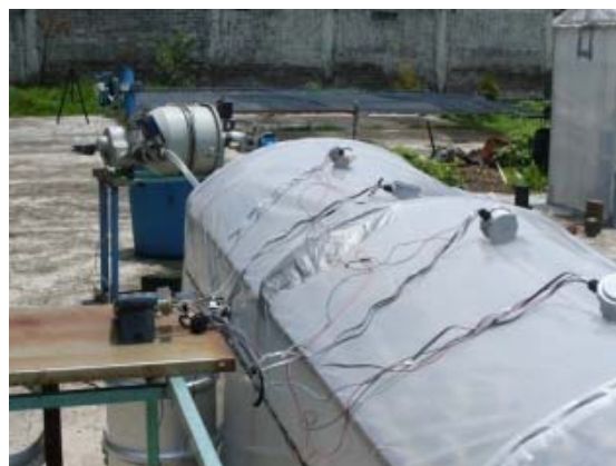
Figura 5. Secador sin retroalimentación (izquierda) y con retroalimentación (derecha) muestreado en diversas zonas.
