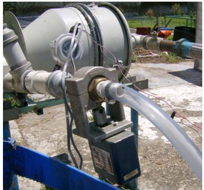
Figura 3. Ubicación del filtro desecante y del sensor de humedad antes de la electroválvula de recirculación.
