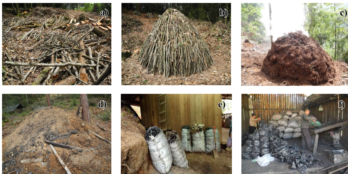
Figura 3. Proceso de elaboración de carbón vegetal. a) corta y secado de la madera, b) armado del horno, c) horneado de madera, d) enfriamiento del horno, e) encostalado para transporte y f) empaquetado para venta (bolsas de 2 kg).
