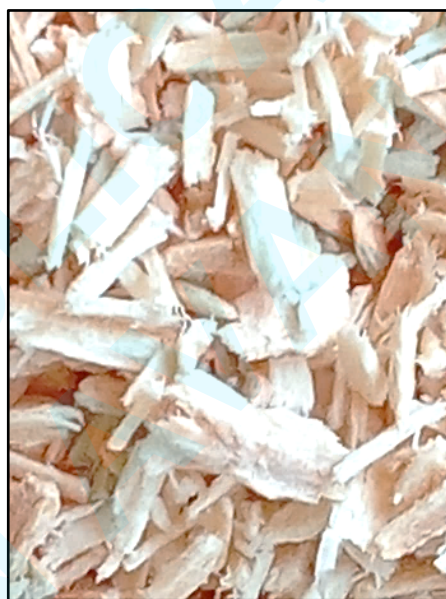
Figura 1. Morfología del aserrín de Pinus pseudostrobus (fracción >850 \mu m , observada con lupa binocular 10x) utilizado para la elaboración de materiales compuestos.
