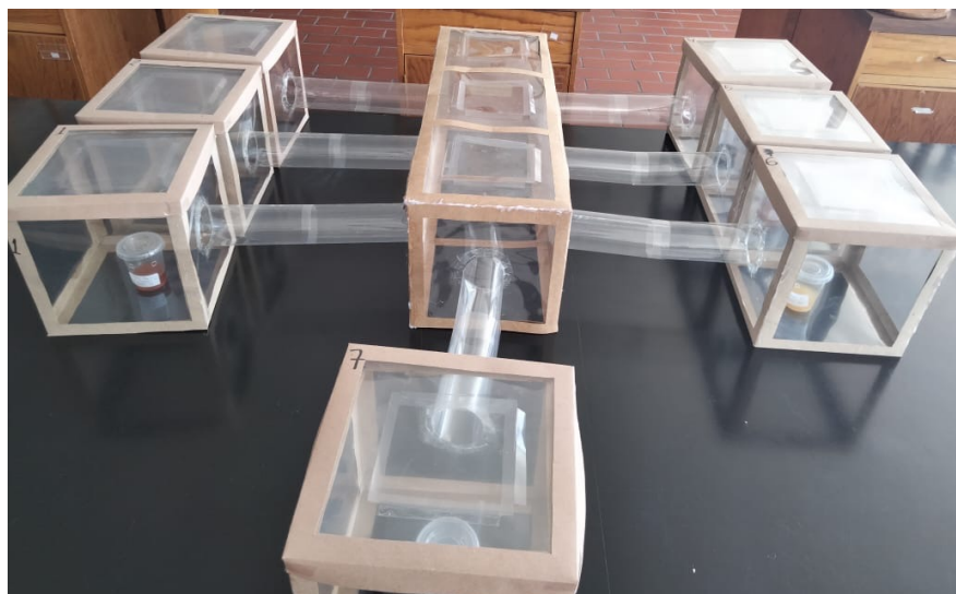
Figura 2. Diseño estructural I, para evaluar atrayentes para la mosca negra del higo ( Silba adipata McAlpine) en condiciones de laboratorio.
